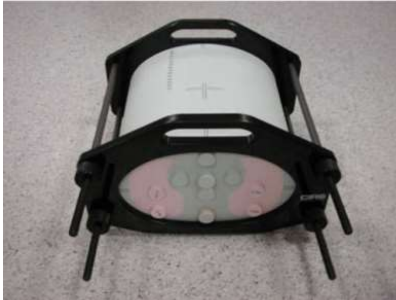
Gambar 2. Fantom CIRS thorax 002LFC yang digunakan dalam audit dosimetri TPS. 15
